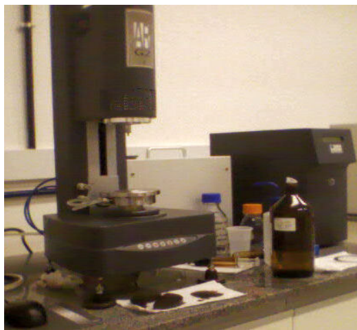
Figura 3: (a) Reômetro AR-G2; (b) Geometria placas paralelas
